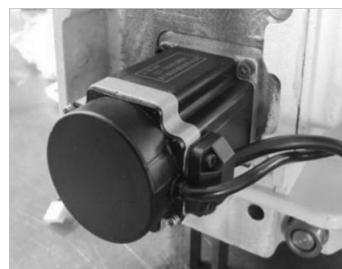
Motorul pas cu pas controlează lungimea cusăturii și realizează o varietate de modele de cusături
